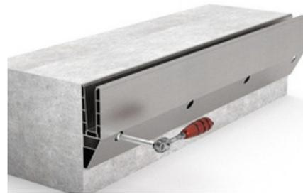
2. Profil platzieren und sichern mit einem auf 40 Nm eingestellten Drehmomentschlüssel.
