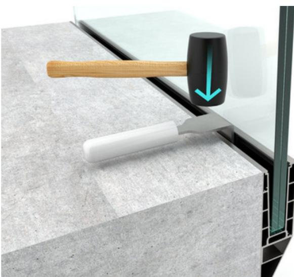
Wenn alle Keile an Ort und Stelle sind, verwenden Sie einen Keileinsetzer und einen Hammer, um sie einzuführen, bis das Glas verriegelt ist.
