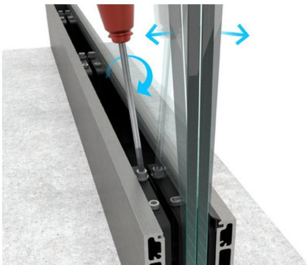
Um eine perfekte Ausrichtung zu erreichen, verwenden Sie die beiden Schrauben. Der erste neigt das Glas in Ihre Richtung, der zweite in die entgegengesetzte Richtung. Wenn die perfekte Ausrichtung erreicht ist, sichern Sie beide Schrauben.
