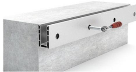
2. Profil platzieren und sichern mit einem auf 40 Nm eingestellten Drehmomentschlüssel.
