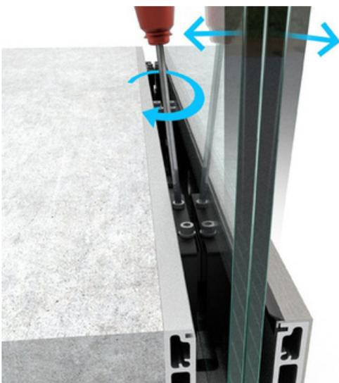
Um eine perfekte Ausrichtung zu erreichen, verwenden Sie die beiden Schrauben. Der erste neigt das Glas in Ihre Richtung, der zweite in die entgegengesetzte Richtung. Wenn die perfekte Ausrichtung erreicht ist, sichern Sie beide Schrauben.
