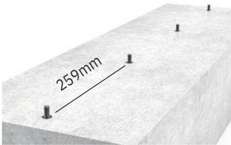
1. Bohren, absaugen, Kleber und Verbundanker einsetzen.
