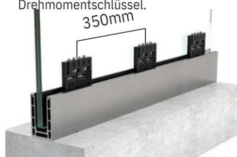
5. Setzen Sie das verstellbare System ein und richten Sie das Glas wie in der größeren Abbildung unten gezeigt aus.
