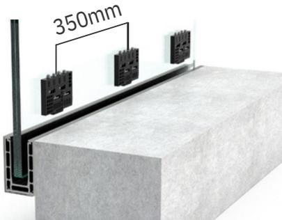
5. Setzen Sie das verstellbare System ein und richten Sie das Glas wie in der größeren Abbildung unten gezeigt aus.
