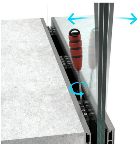
Das Erreichen einer perfekten Glasausrichtung ist einfach. Die beiden Schrauben ohne Unterlegscheibe neigen das Glas zu Ihnen, und die beiden mit Unterlegscheibe neigen es in die entgegengesetzte Richtung. Wenn eine perfekte Ausrichtung erreicht ist, ziehen Sie alle anderen Schrauben fest.
